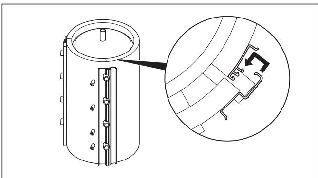
Abb. 4.10 Klemmleisten einrasten
