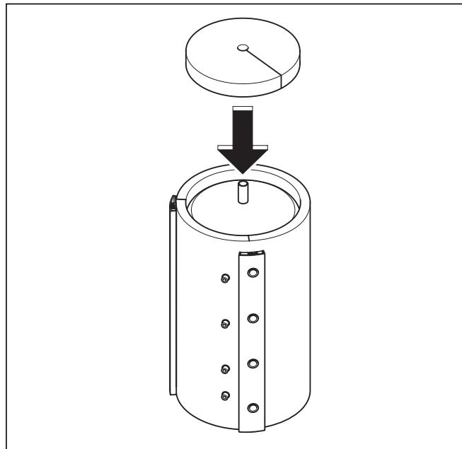
Fig. 4.11 Pose du rembourrage supérieur
