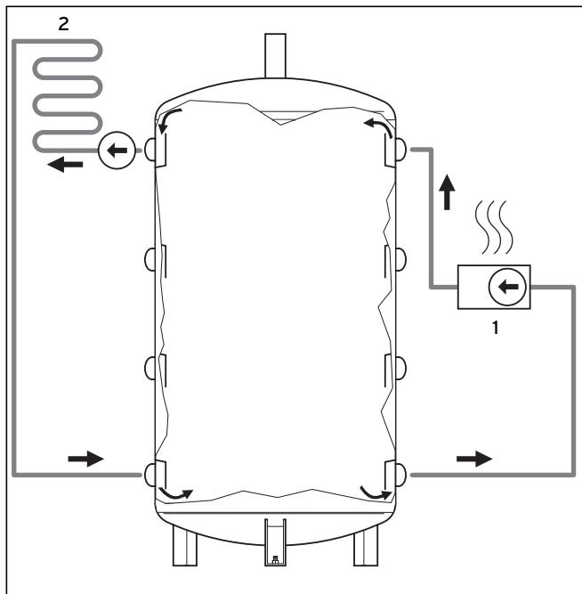
Afb. 2.1 Werkingsprincipe van het buffervat
