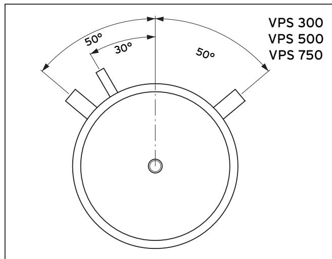
**Fig. 4.5 Angles des raccords au dos de l'appareil
