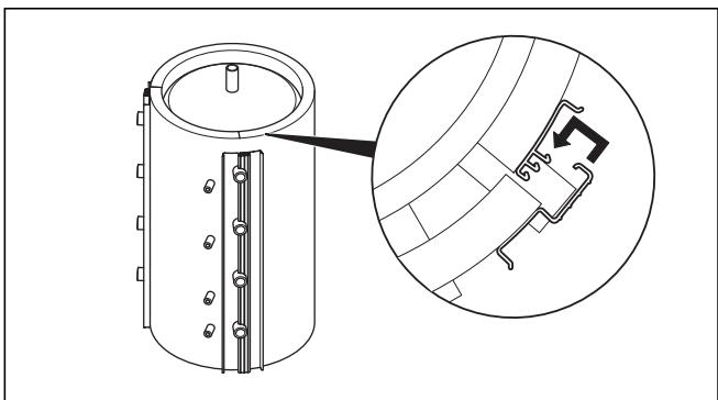
Fig. 4.10 Emboîtement des réglettes d'attache
