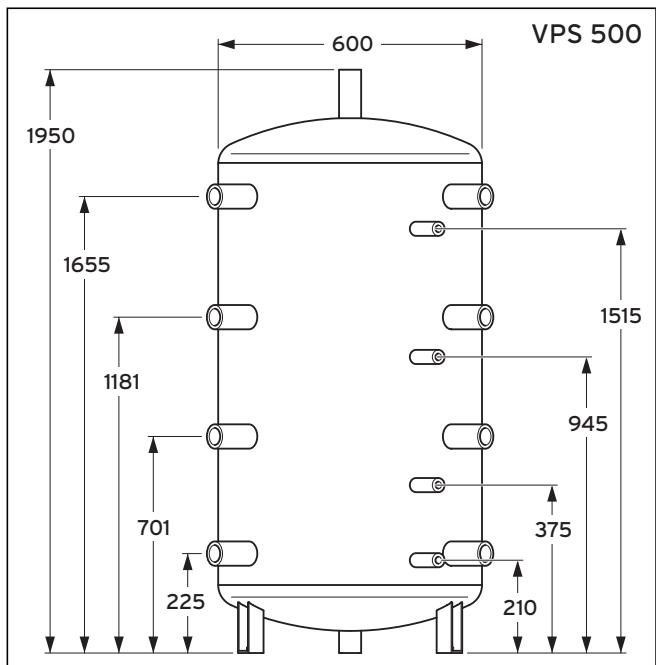
Abb. 4.3 Abmessungen VPS 500 \*
