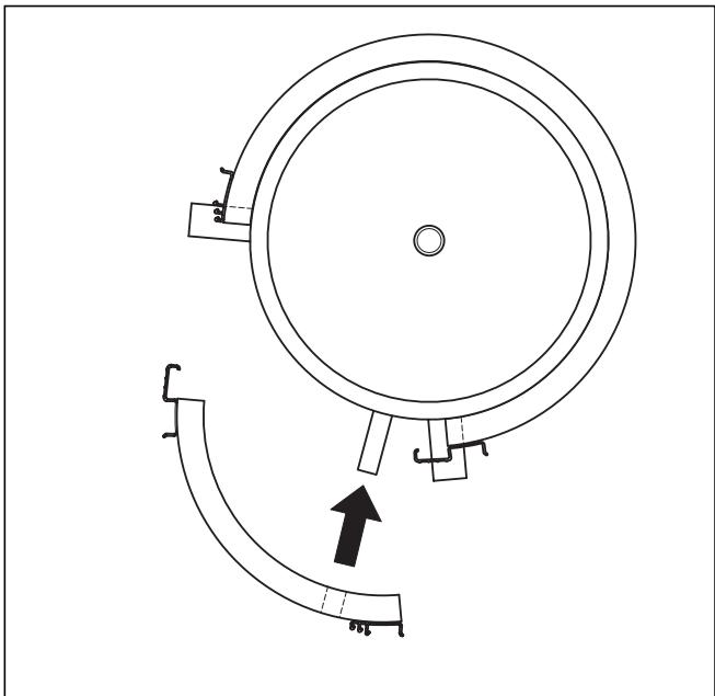
Fig. 4.9 Montage de la coque d'isolation arrière (vue d'en haut)
