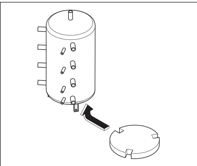
Afb. 4.7 Voetvulling aanbrengen
