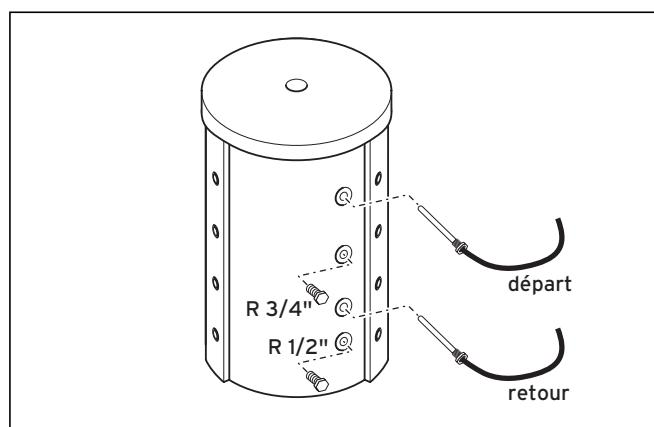
Fig. 5.2 Raccordement des sondes de température et bouchons
