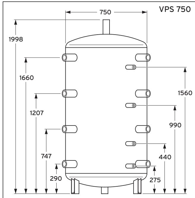
Abb. 4.4 Abmessungen VPS 750 \*
