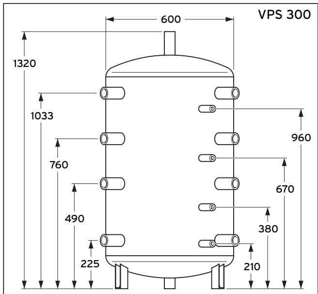
Abb. 4.2 Abmessungen VPS 300 \*
