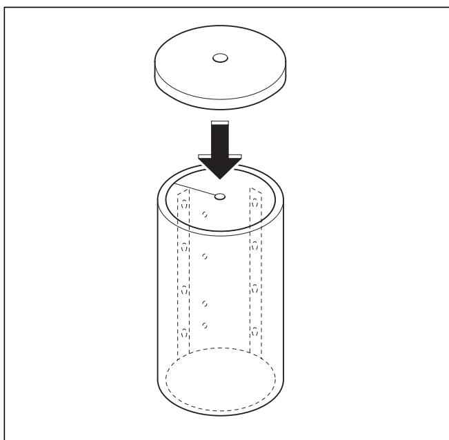
Abb. 4.13 Deckel aufsetzen
