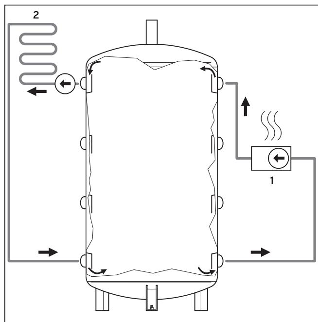
Bild 2.1 Ackumulatortankens funktionsprincip
