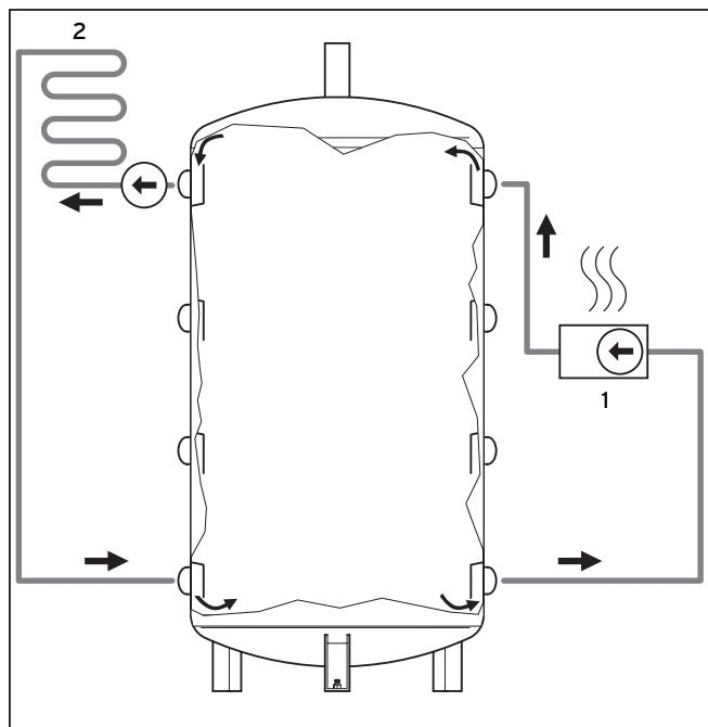
Fig. 2.1 Bufferbeholderens funktionsprincip
