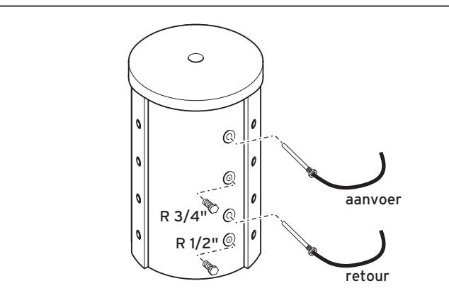
Afb. 5.2 Aansluiting voor temperatuursensor en stoppen
