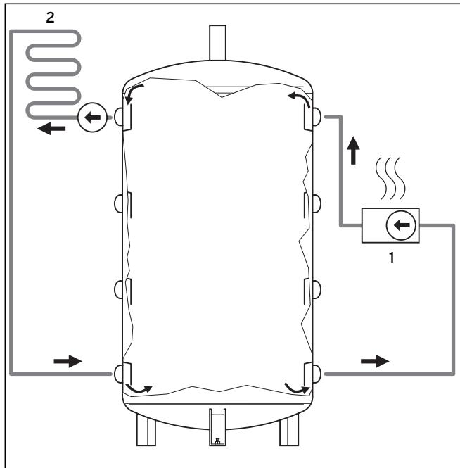
Fig. 2.1 Principe de fonctionnement du ballon tampon
