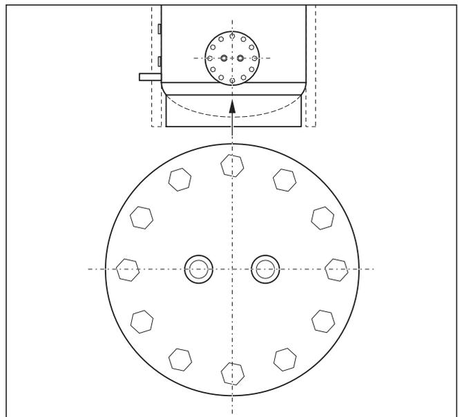
Abb. 4.1 Positionierung des Wärmetauschers VPA WT 15
