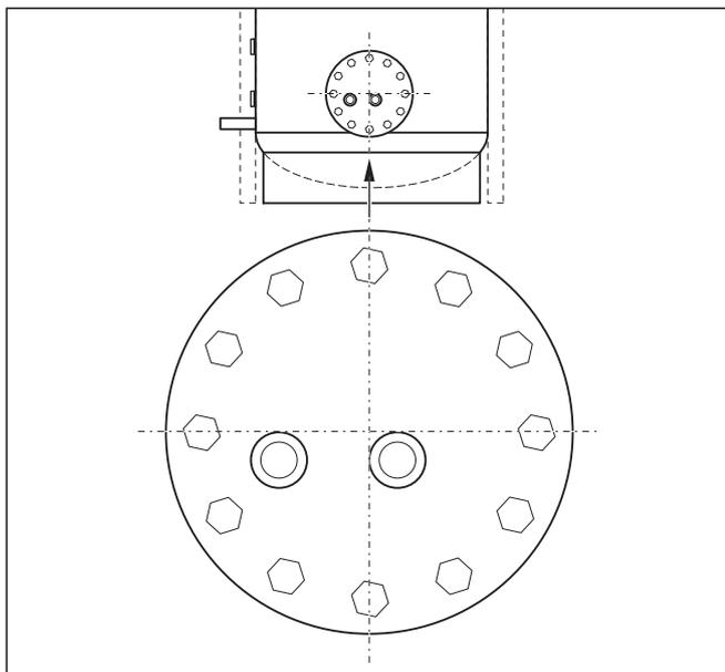
Rys. 4.2 Ustawianie wymiennika ciepła VPA WT 20 i VPA WT 30
