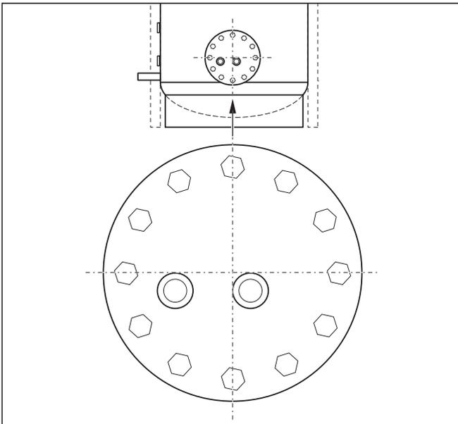
Fig. 4.2 Positionnement des échangeurs thermiques VPA WT 20 et VPA WT 30
