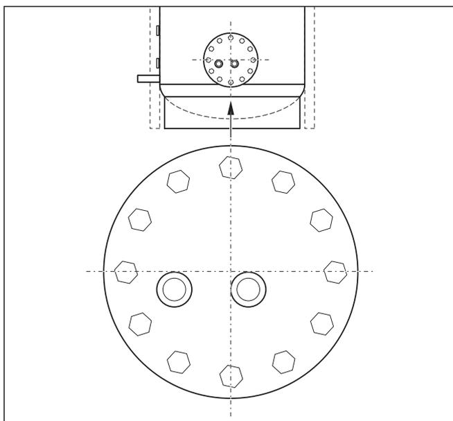
4.2. att. Siltummaiņa pozicionēšana VPA WT 20 un VPA WT 30
