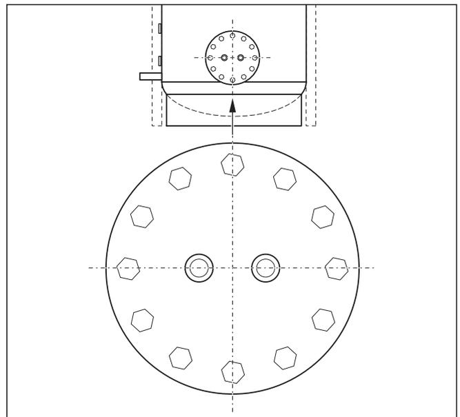
Bild 4.1 Positionering av värmeväxlaren VPA WT 15
