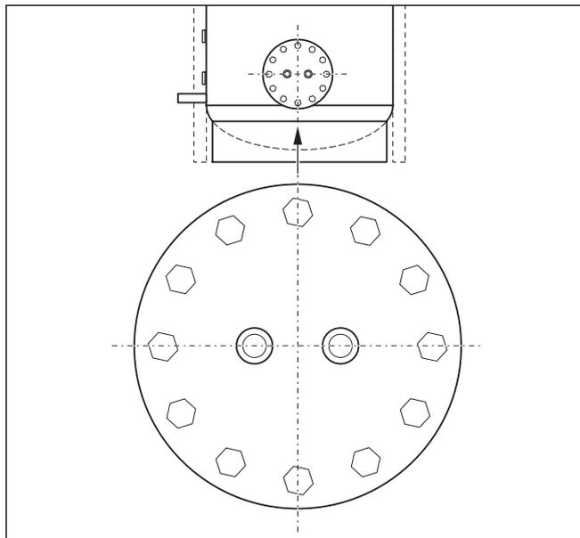
4.1. att. Siltummaiņa pozicionēšana VPA WT 15
