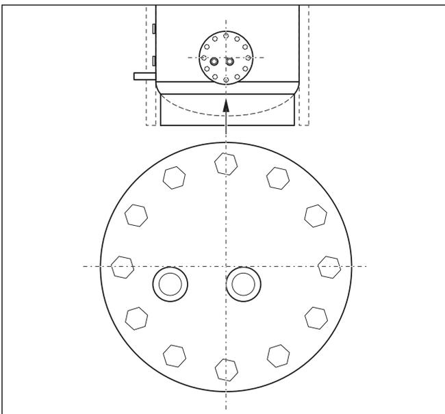
Kuva 4.2 Lämmönvaihtimien VPA WT 20 ja VPA WT 30 asennon valinta
