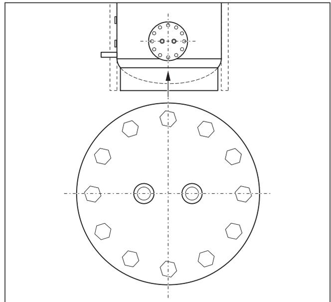
Fig. 4.1 Positionering af varmeveksleren VPA WT 15
