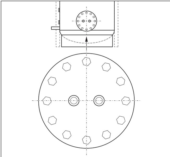
Fig. 4.1 Posizionamento dello scambiatore di calore VPA WT 15
